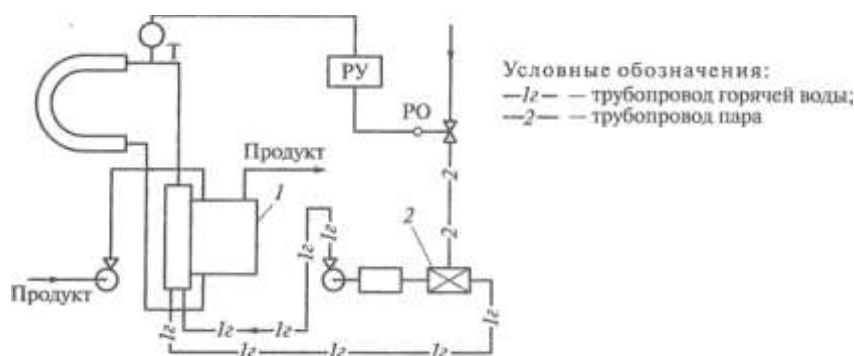
Рис.2.Схема САР по отклонению: 1-секция пастеризации;2- инжектор
